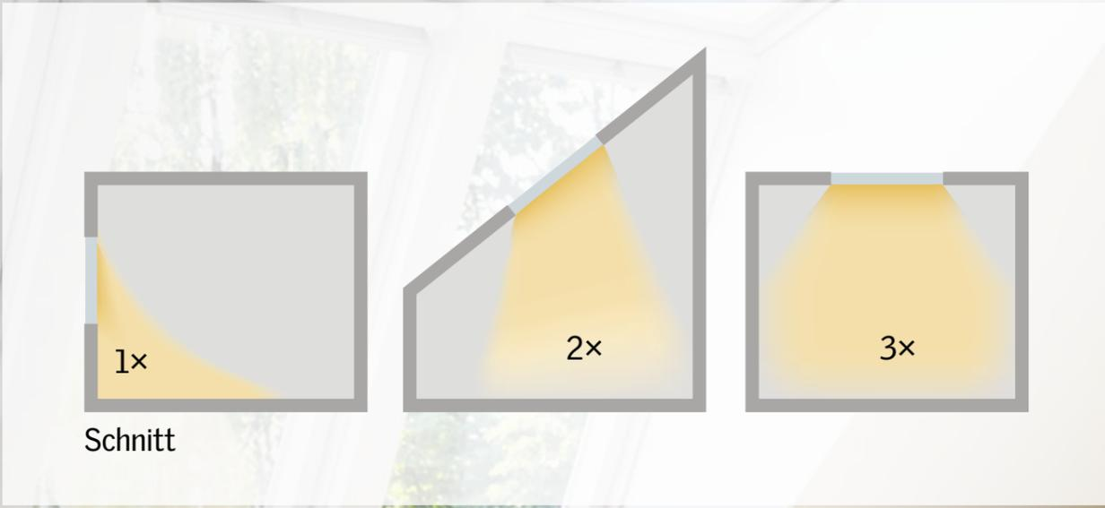
Verteilung von diffusem Tageslicht im Raum bei unterschiedlicher Position der Fenster.
